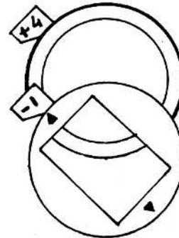
En plus de la lecture dans l'ordre de l'écriture internationale, cette façon de procéder a l'intérêt de permettre la lecture de l'axe même quand les verres sont mal centrés sur l'appareil.
